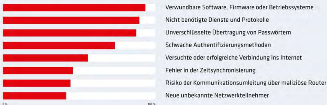
Abbildung 2: Die am häufigsten in OT-Netzen identifizierten Anomalien der letzten fünf Jahre (Bild: Rhebo)
